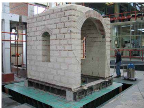
図 4-20 震動台にセットされたグラウト前の丸天井構造物の模型 (Miltiadou, 2009)
