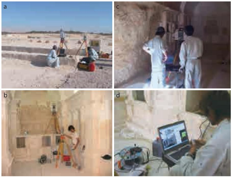
図51 修復後のF・H号墓の3次元計測とその作業風景
