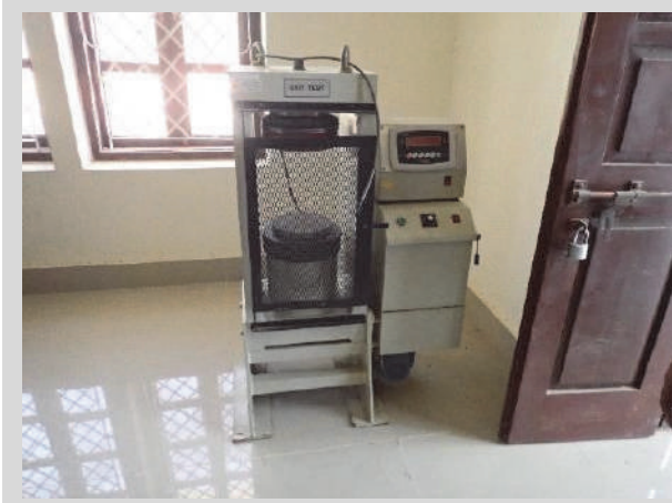
図 123 接着剤の強度を測定するための強度試験機。圧縮強度を指標としている。
