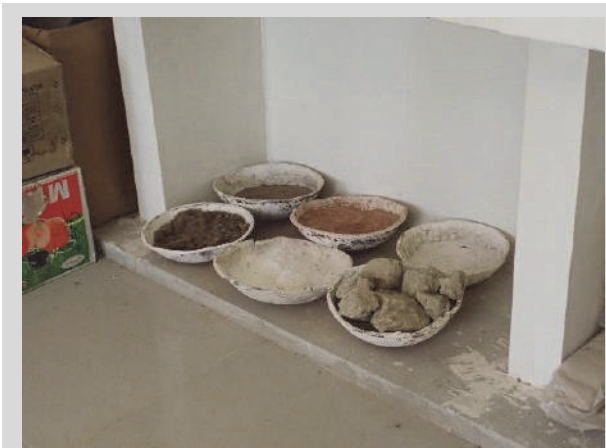
図 122 石膏を主剤とする接着剤の配合試験。様々な土を使った実験をしている。
