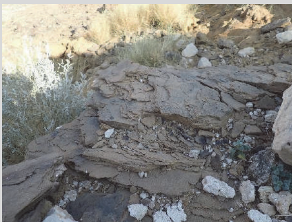
図 115 地盤を構成している砂岩層。板状に割裂している。
