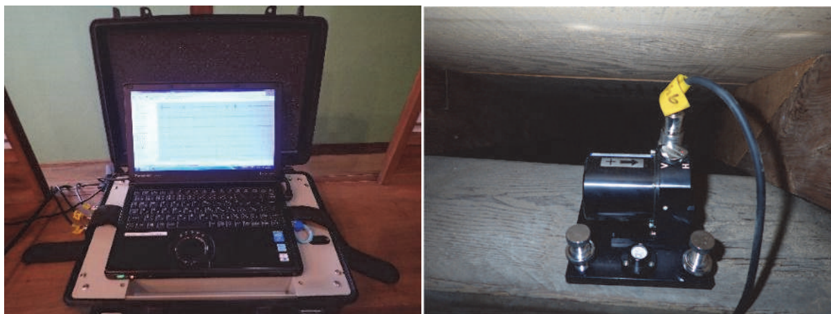
図 38 計測機器（左：携帯型高感度振動計 | 右：サーボ型速度計）。
